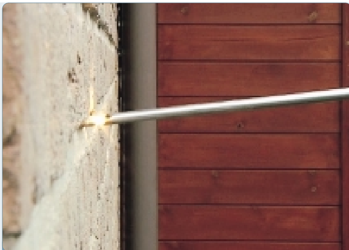
Er wordt eerst een endoscopisch onderzoek gedaan om te zien hoe de spouwmuur eruitziet
